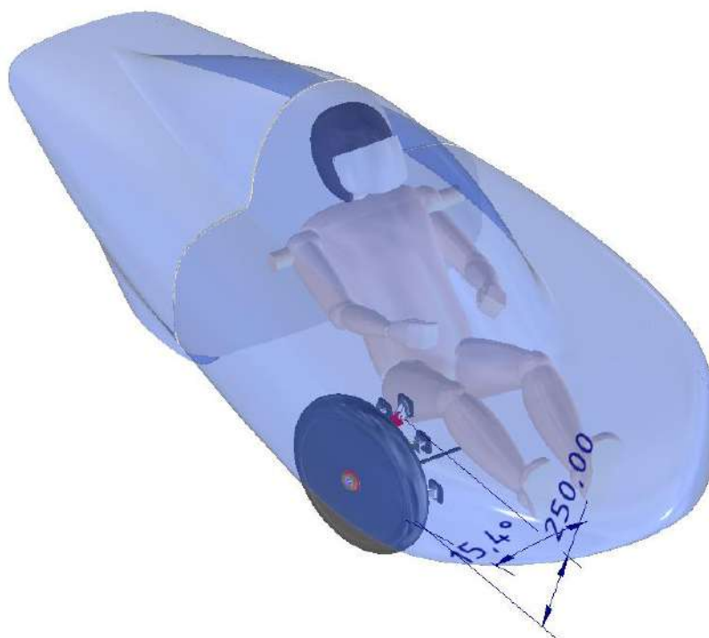
27. ábra Első futómű a karosszériaformában [Saját szerkesztés]
