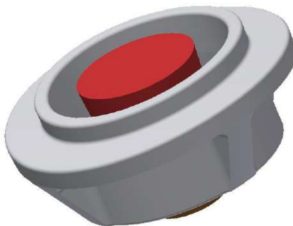
45. ábra Vész-ki gomb 3D nyomtatott ház [Saját szerkesztés]
