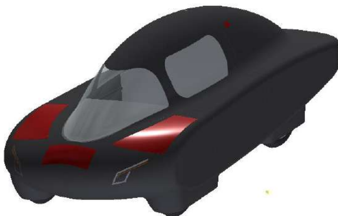
5-7. ábra Szerelő nyílások elhelyezkedése a járművön (pirossal jelölve)
