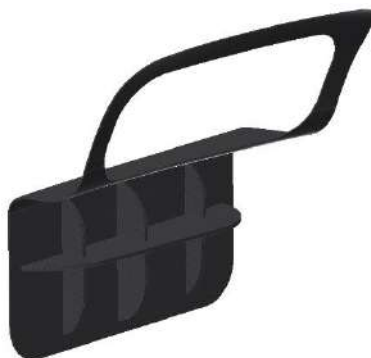
5-8. ábra Ajtó merevítése borda alkalmazásával
