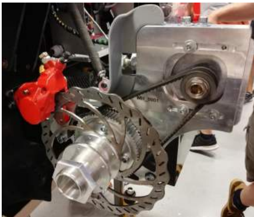
48. ábra A megvalósult és összeszerelt Allied Motion hajtáslánc
