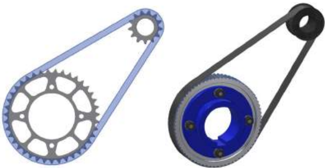
47. ábra A szíjhajtás és a lánchajtás részösszeállítása
