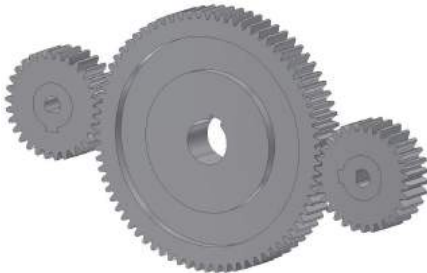
25. ábra A fogaskerékkapcsolat 3D CAD modellje
