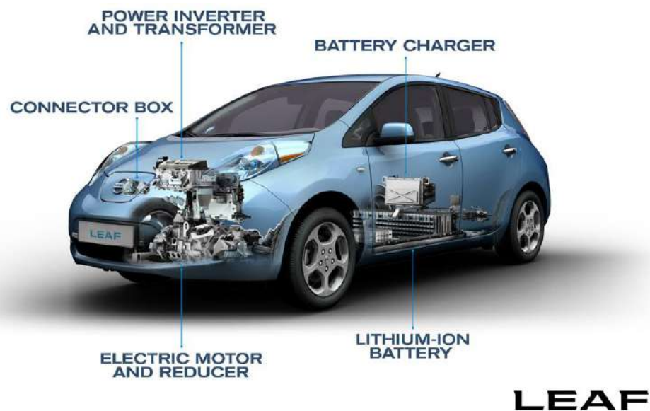
26. ábra: A Nissan Leaf technikai áttekintő ábrája. [A10]
